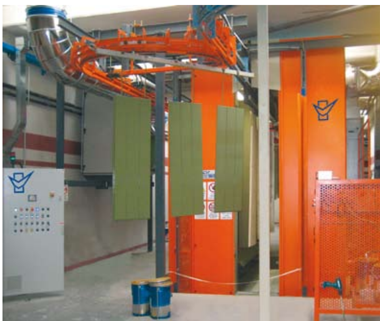
7 - La cabina di verniciatura (GIVI 3000) realizzata dalla Vidali Impianti 2. 7 – The paint booth (GIVI 3000) developed by Vidali Impianti 2.
