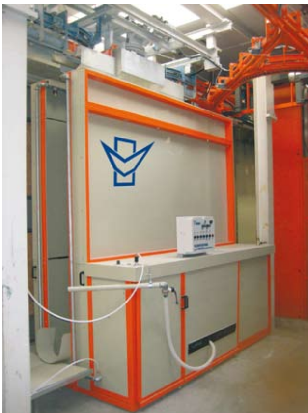
4 – Il flow-coating con sistema di controllo automatico e chiarificatore integrato. Quando non operativo può essere spostato fuori linea. 4 – The flow-coating equipment with automatic control system and built-in clarifier. When not in use, it can be moved out of the line.
