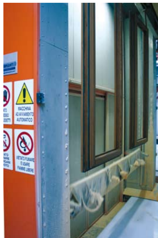
8 - L'interno della cabina di verniciatura, con reciprocatore a 5 pistole elettrostatiche (Wagner Colora). 8 – The inside of the paint booth with 5-gun electrostatic reciprocator (Wagner Colora).
