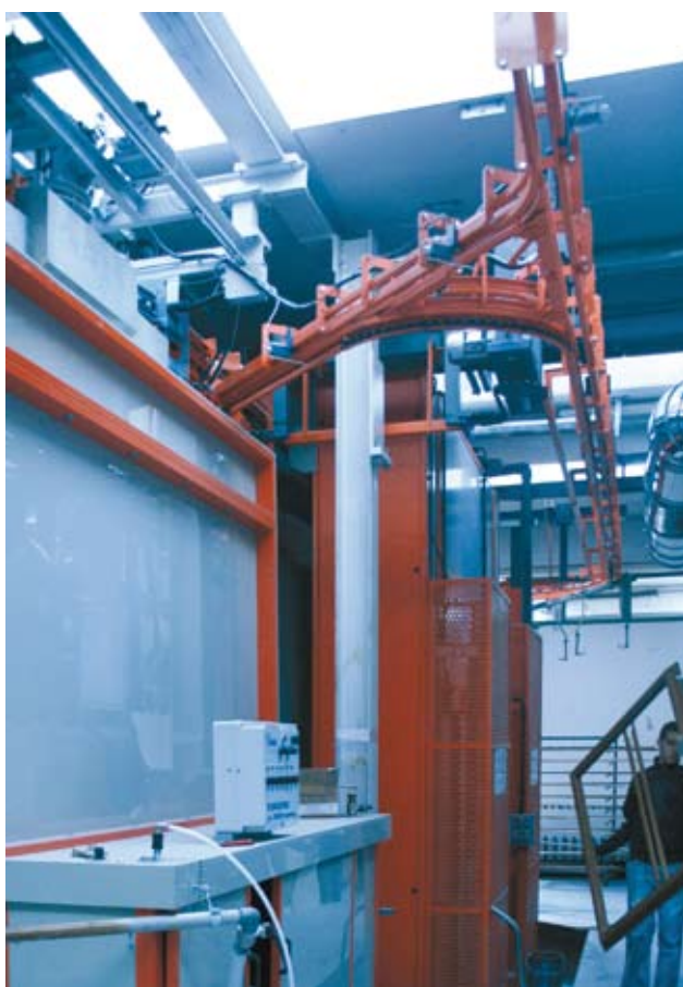
9 - Il movimento rotatorio della barra di sostegno dei pezzi con il sistema Turn Around.
